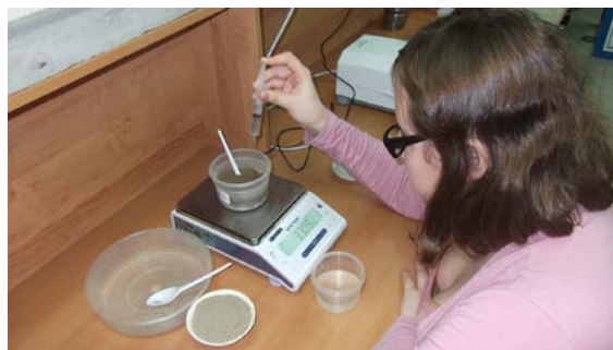
Рис. 2. Подготовка песчаного грунта заданной влажности
