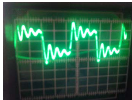
Рис. 12. Осциллограмма в точке внутри взаимосвязанных катушек при наличии в их структуре области к.з. при воздействии прямоугольных импульсов
