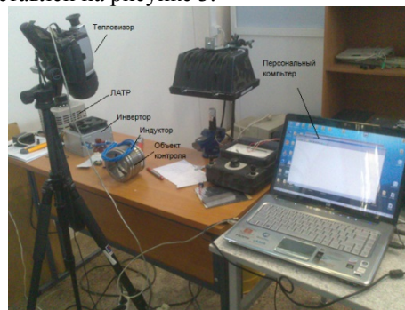
Рисунок 3. Тепловизионный дефектоскоп с индукционной стимуляцией.
