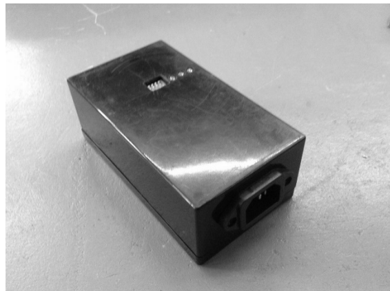
Рис. 6 – Готовый прототип устройства с внутренней антенной
