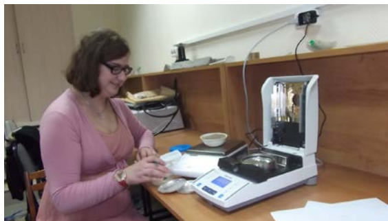
Рис. 1. Анализ влажности грунта с помощью галогенного анализатора влагосодержания
