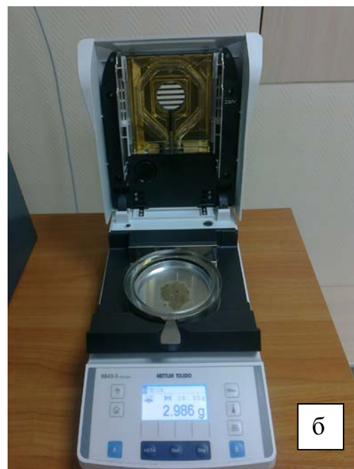
Рис. 1. Лабораторное определение насыпной плотности (а) и влажности (б) песчаного грунта
