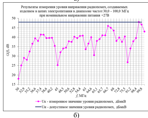
Рис.2. Результаты измерения уровня помехоэмиссии изделия G(f) при номинальном напряжении питания +27В в диапазоне частот f : а) 0,01 МГц – 30 МГц, б) 30 МГц – 100 МГц.
