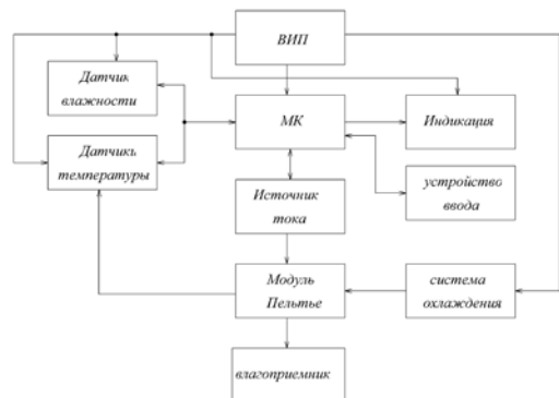
Рис.1 структурная схема осушителя воздуха, где ВИП – вспомогательный источник питания, МК – микроконтроллер.
