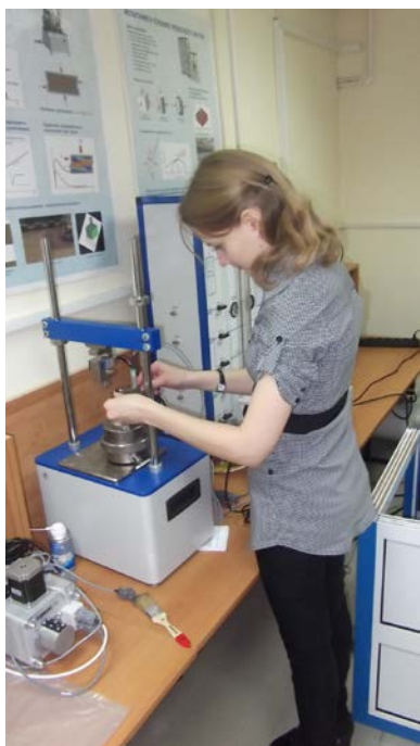
Рис. 2. Проведение компрессионных испытаний песчаного грунта
