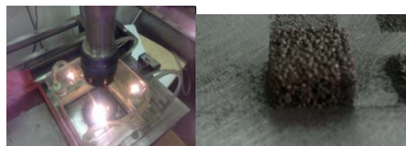
Рис. 1. Спекание порошка по SLS-технологии
