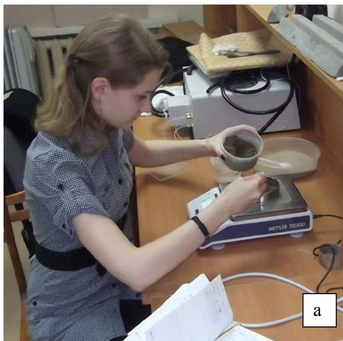
Рис. 1. Лабораторное определение насыпной плотности (а) и влажности (б) песчаного грунта
