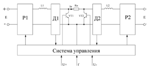
Рис.1. Общая структурная схема источника асимметричного тока или напряжения на основе непосредственных преобразователей.
