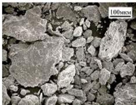
Рисунок 1. Фотографии структуры порошковой смеси при времени активации 90с (а) и 120с (б).
