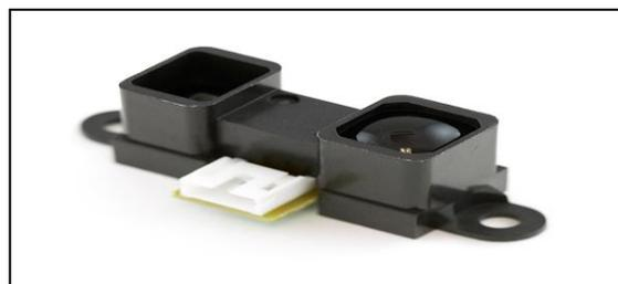
Рис.2. Инфракрасный датчик расстояния
