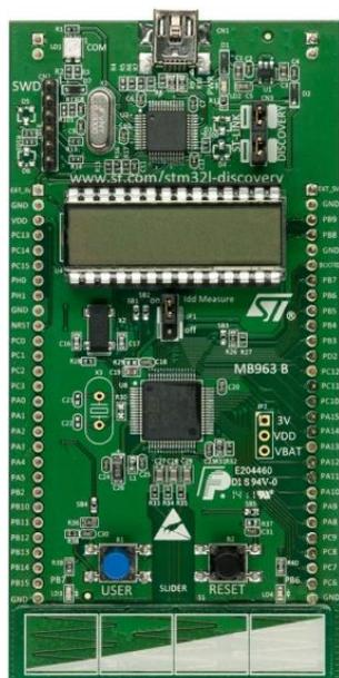
Рисунок 3 – Отладочная плата Stm32L-DISCOVERY
