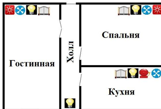
Рис. 1. Схема помещения и система Smart Home
