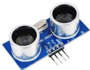
Рис. 1. Ultrasonic Module HC-SR04
