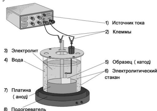
Рис.1. Стенд для электролитического насыщения образцов водородом
