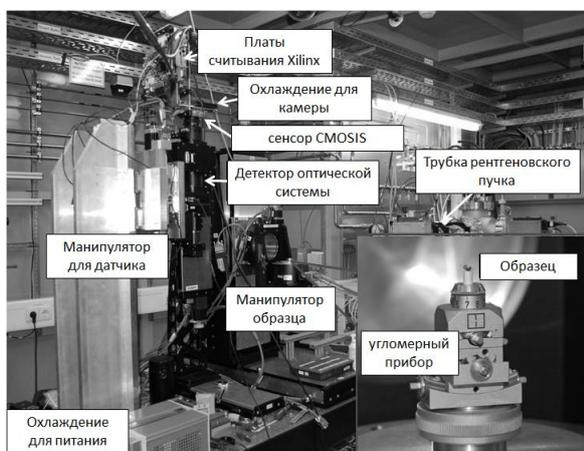
Рис. 1. Экспериментальная станция
