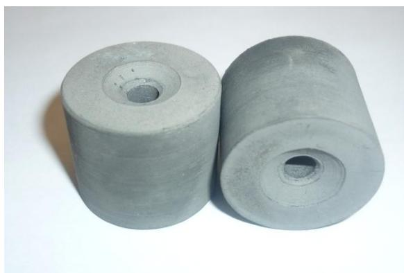
Рис.3. Правильная втулка после диффузионного упрочнения
