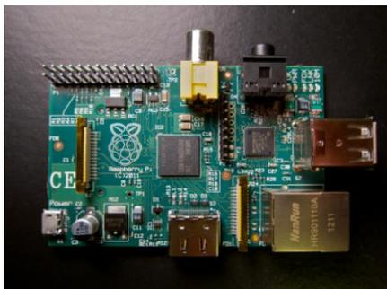
Рис. 2. Одноплатный компьютер Raspberry Pi
