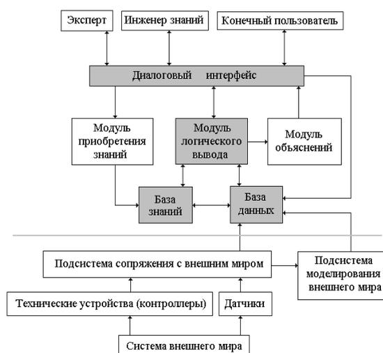
Рис. 1. Структура экспертной системы реального времени
