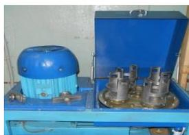
Рис. 1. Планетарная шаровая мельница "Активатор – 4S"
