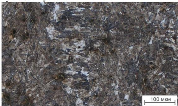
Рис. 2. Структура заэвтектоидной стали, сформированная при наплавке с током пучка электронов 26 мА
