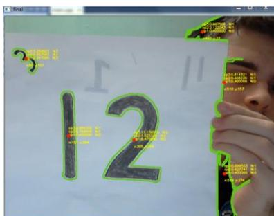
Рис. 5. Сравнение контуров кадра с контурами шаблонов
