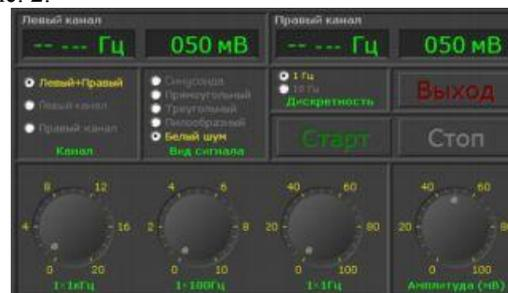
Рис. 2. Программа генератора звуковых частот
