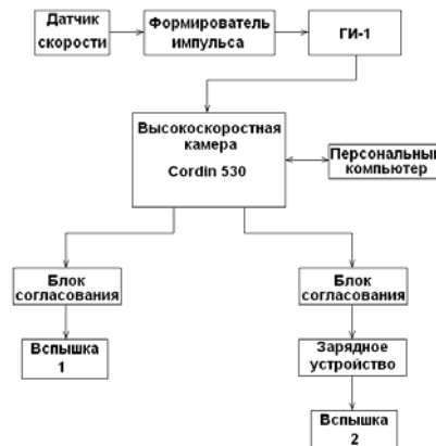
Рис. 2. Схема подключения периферийного оборудования к высокоскоростной камере «Cordin 530» .
