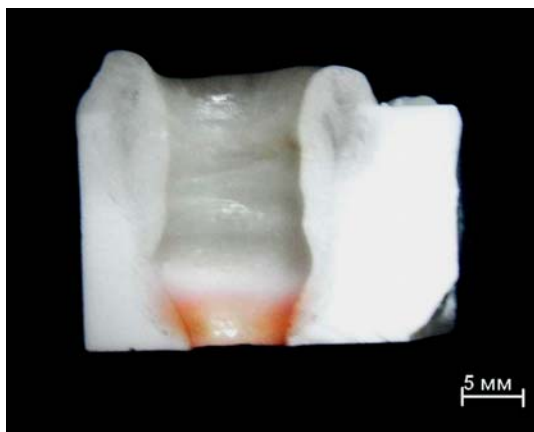
Рис. 2. Поперечное сечение отверстия, полученного в результате электронно-лучевого воздействия на алюмооксидную керамику ВК94-1. Диаметр пучка 4 мм, удельная мощность 17 кВт/см 2
