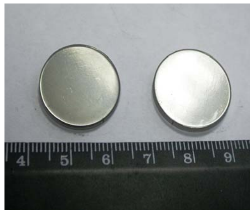
Рис.1 Образцы, после двустороннего прессования смеси порошков никеля УТ-4 и алюминия АСД-6.
