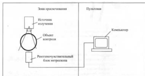
Рисунок 1 - Схема рентгеновского контроля качества изделий
