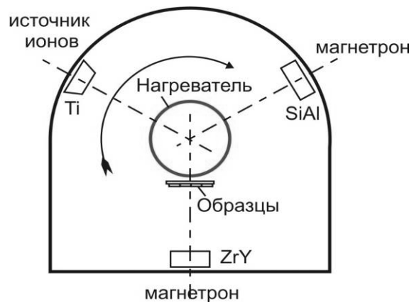
Рис. 1. Схема нанесения многослойных покрытий
