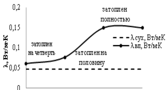
Рис 2. Изменение величины коэффициента теплопроводности пенополиуретана в зависимости от уровня затопления водой изоляционного слоя.
