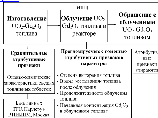
Рис. 1. Технологические этапы обращения с уран-гадолиниевым топливом
