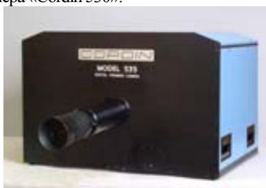
Рис. 1. Внешний вид высокоскоростной видеокамеры «Cordin 530».
