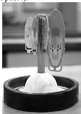
Рис.4. Елочка: сборка восковых моделей на литниковую систему.
