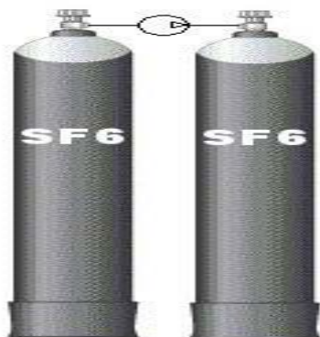
Рисунок 2. Простейшая схема регенерации элегаза. Два баллона объединяют «сухим» компрессором по пару и перекачивают газ в пустой баллон.
