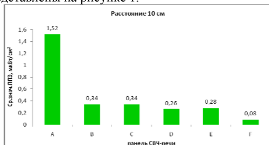
Рис.1. Измерения ЭМИ микроволновой печи на расстоянии в 10 см
