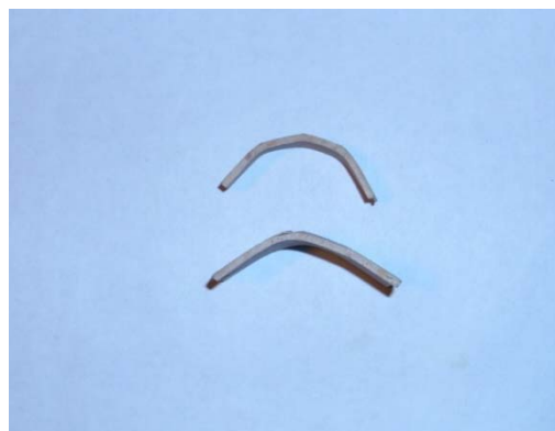
Рис.1. Гнутые образцы из бука, полученные в результате третьего эксперимента.
