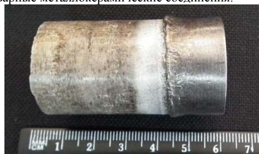
Рис.4. Металлокерамическое сварное соединение керамики на основе талько-шамотной смеси с титаном (титан справа)
