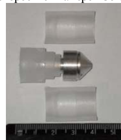
Рис. 3. Внешний вид метаемого тела в разобранном виде.
