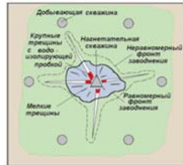
Рис.3 Выравнивание фронта заводнения нефтяного месторождения
