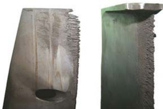
Рис. 1. Лопатки ротора паровой турбины 5-й ступени (К-300, К-500) после эксплуатации (характерный вид эрозионных повреждений)
