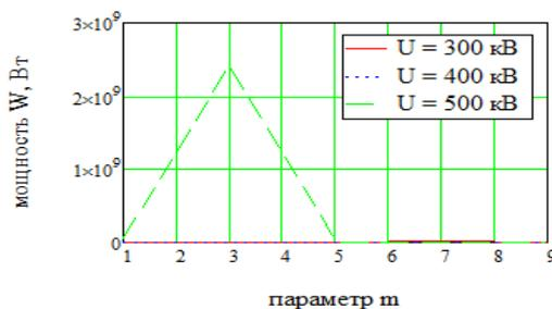
Рис. 5. График зависимости мощности излучения от напряжения на катодах при постоянном радиусе пучка и диодном зазоре.
