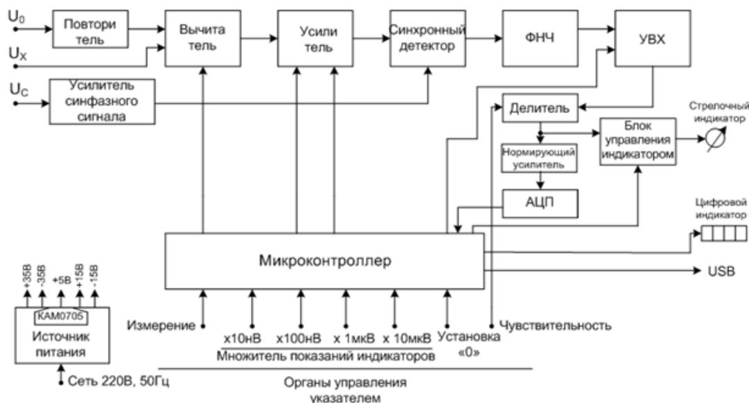
Рис. 4. Структурная схема указателя
