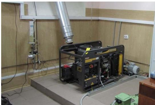
Рис. 2 – Внешний вид стэнда дизель-генератора
