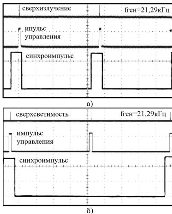
рис.1 Осциллограммы работы лазерного монитора при различной частоте съёмки
