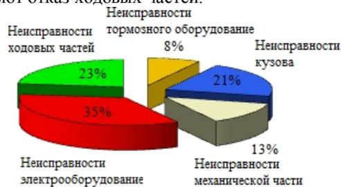
Рис. 3. Отказов основных узлов трамвайного вагона
