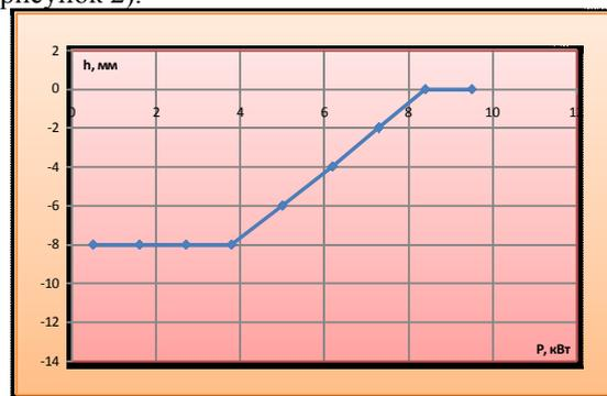
Рис. 2 – Функциональная зависимость положения рейки топливного насоса от электрической нагрузки ДГ, обеспечивающая минимальный расход топлива
