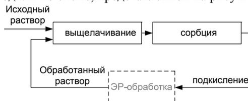
Рисунок 1. Схема проведения выщелачивания. Пунктиром показана возможность исключения стадии электроразрядной обработки.
