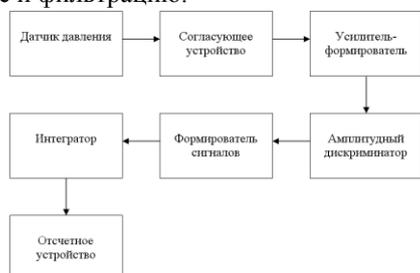
Рис.2. Блок-схема прибора для определения угла опережения впрыска топлива
