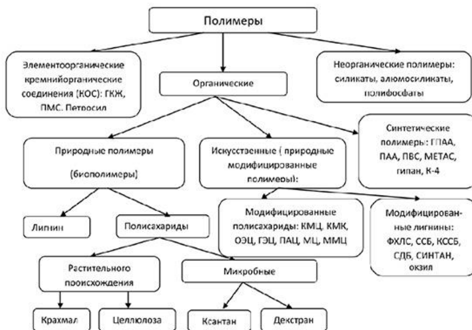
Рис. 3. Классификация полимеров, применяемых в буровых растворах
