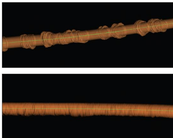
Рис. 2. Сравнение качества ствола скважины, построенного по данным каверномера: сверху – забойный двигатель с кривым переводником, снизу – роторная управляемая система [1]
