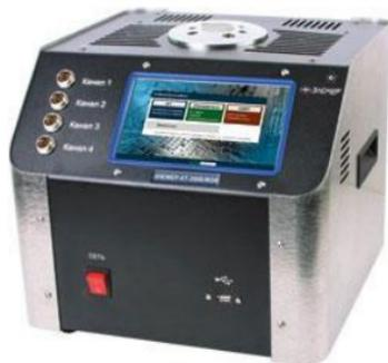
**ЭЛЕМЕР-КТ-150К** — компьютеризированный калибратор температуры с измерительным модулем используется в качестве рабочего эталона (поверочной установки) при поверке и калибровке термометров сопротивления (ТС), преобразователей термоэлектрических (ТП), платиновых ТС с индивидуальными статическими характеристиками преобразования, термопреобразователей с унифицированным выходным сигналом.
