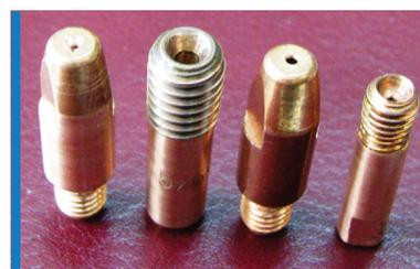
Токоподводящие наконечники, применяемые для полуавтоматической сварки в среде защитных газов
