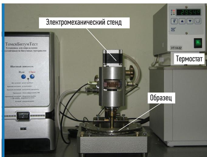
Рис. 2. Общий вид автоматизированной установки ТомскБитумТест
