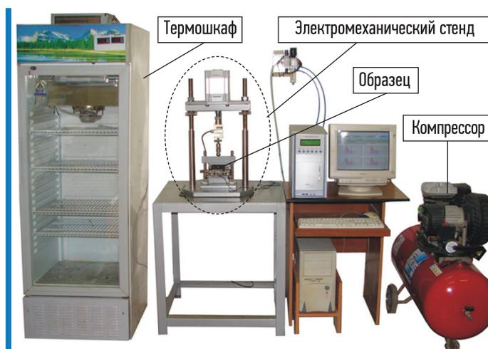
Рис. 1. Общий вид автоматизированной установки ТомскАсфальтТест
