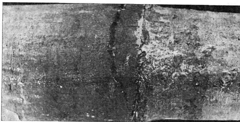
*Рис. 106. Поперечные трещины на литом электроде сплава XH56BMTY*
