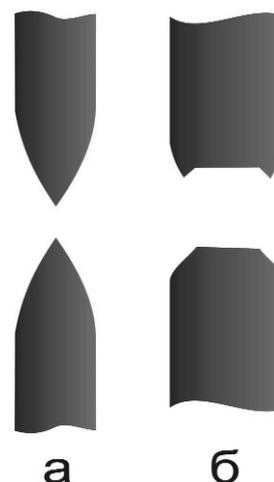
Рис. 98. Виды шеек при растяжении:
