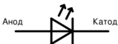
*Рис. 31. Обозначение светодиода в электрических схемах*
