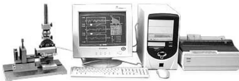
*Рис. 77. Профилограф-профилометр «Абрис-ПМ7»*
