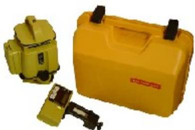
*Рис. 70. Лазерный ротационный нивелир*
