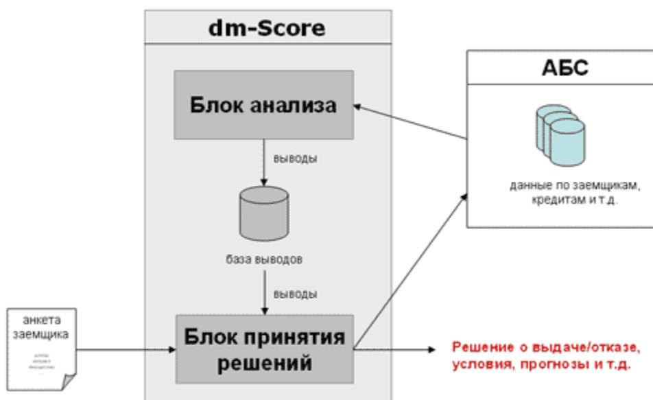
**Рис. 28.2.** Устройство системы dm-Score
