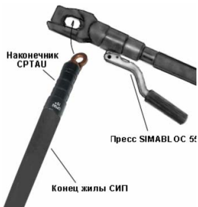
Рис. 1.26. Ручной пресс для монтажа наконечников СИП
