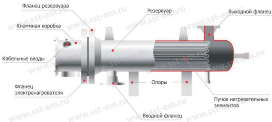
Рис. 3. Устройство проточного электронагревателя
