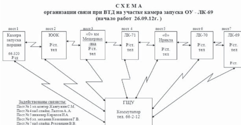
Рис. 1. Пример схемы организации связи при проведении ВТД
