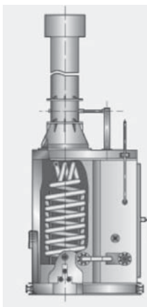
Рис. 1. Классический подогреватель газа с контрольно-запальным устройством
