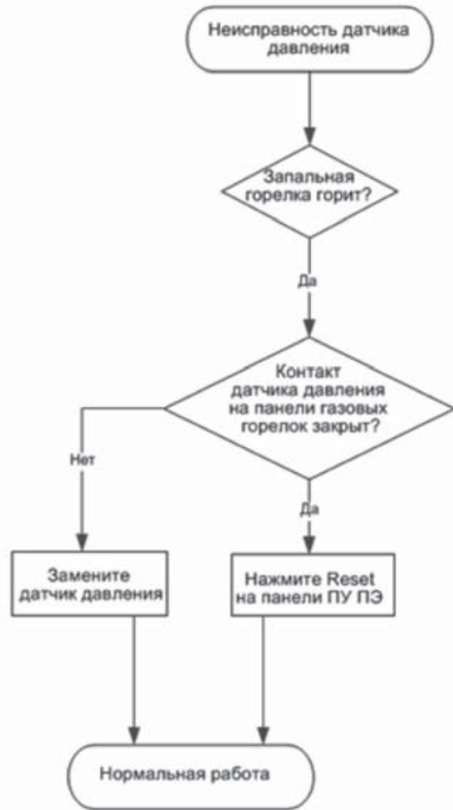
Рис. 1. Алгоритм поиска неисправности датчика давления газа
