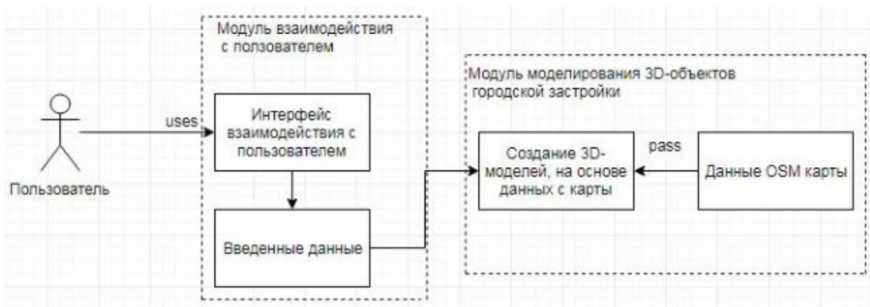
Рисунок 2 – Архитектура системы трехмерного моделирования городской застройки
