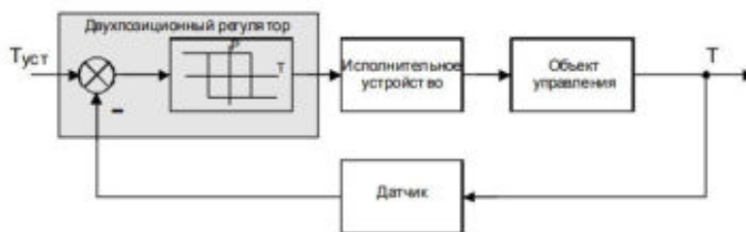
Рис. 1. Функциональная схема системы стабилизации температуры
