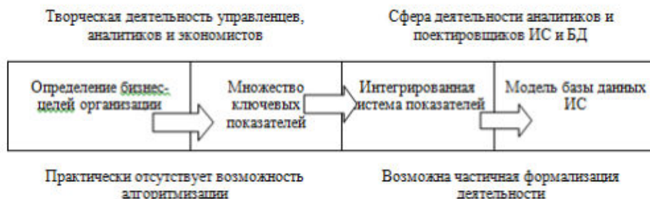
Рисунок 3 - Цепочка отображений при разработке или реинжиниринге базы данных информационной системы организации
