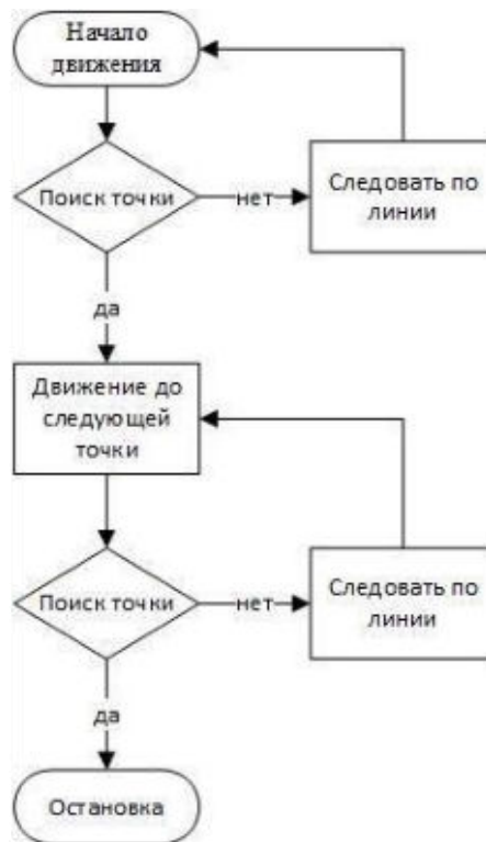
Рис. 2. Блок-схема алгоритма движения пешехода
