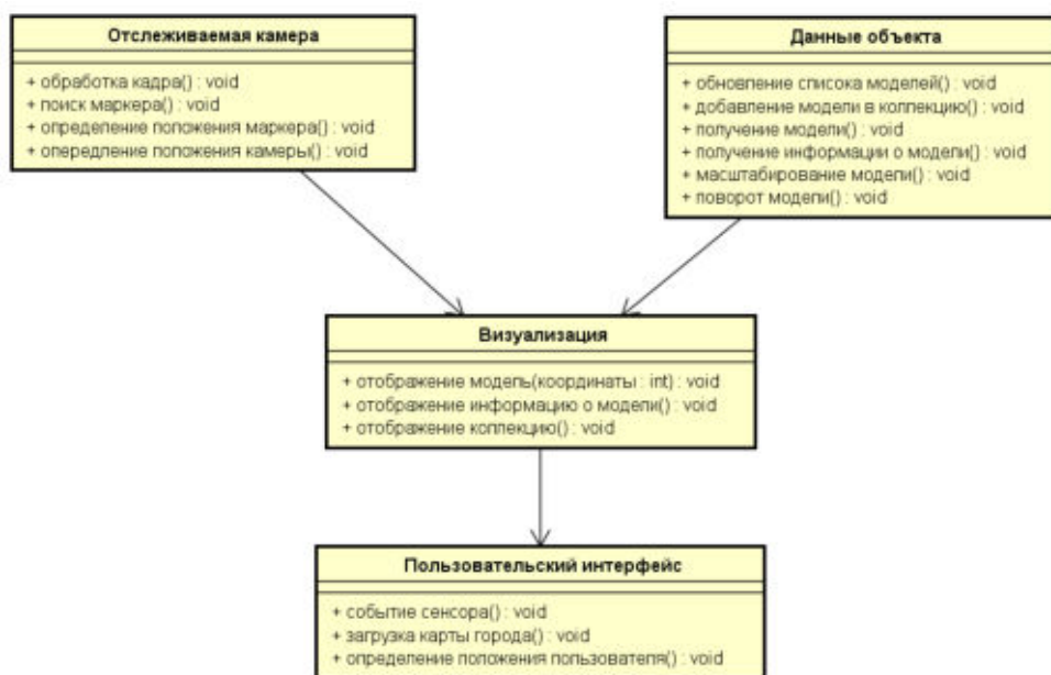
Рисунок 1 – Архитектура мобильного AR-приложения
