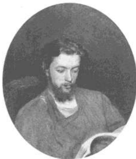
Рисунок 2- Оттиск печати на ризографес линеатурой 68 лин/дюйм периодического растра и углом поворота растра 45 градусов
