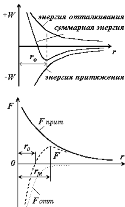
Рис. 2.1. Графики энергии и сил взаимодействия между ионами
