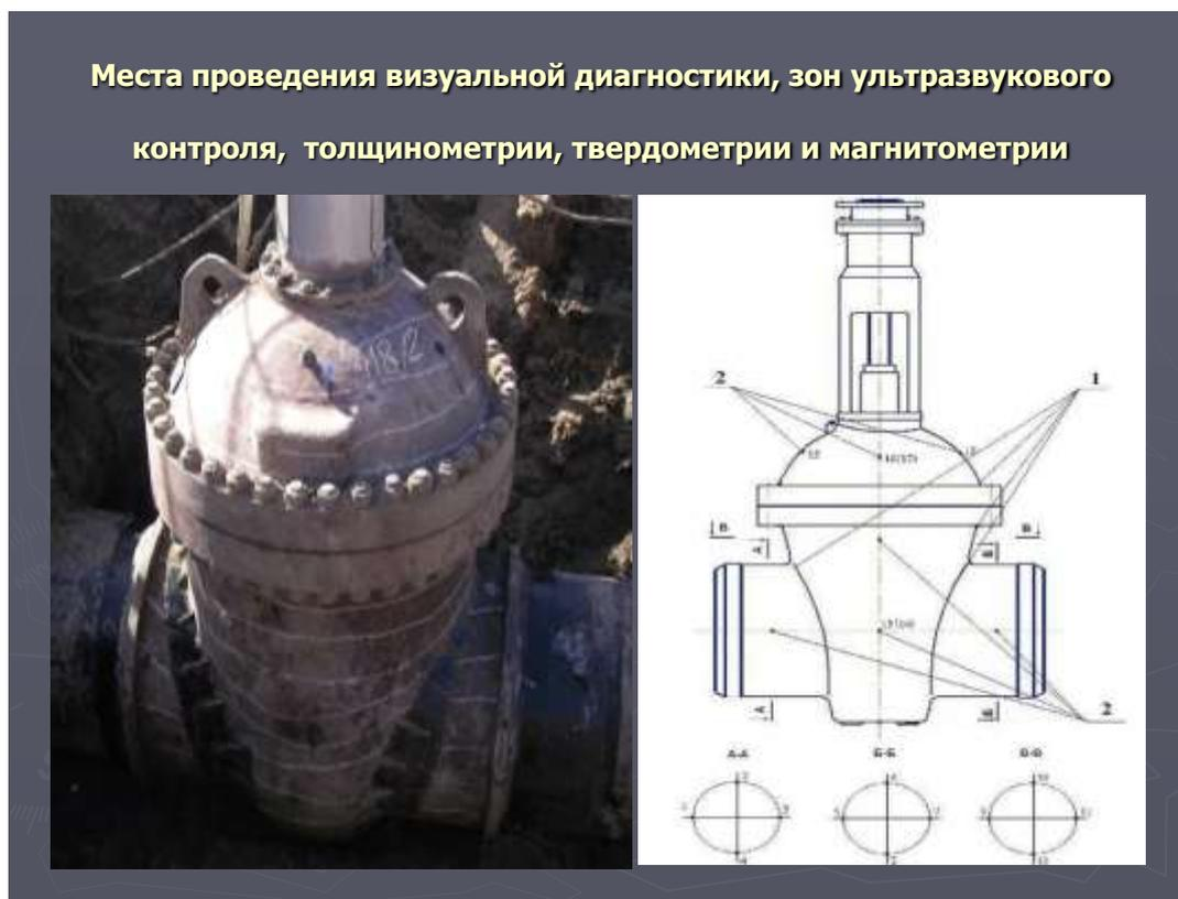
Рис. 6.2.3. Места проведения диагностики задвижки
