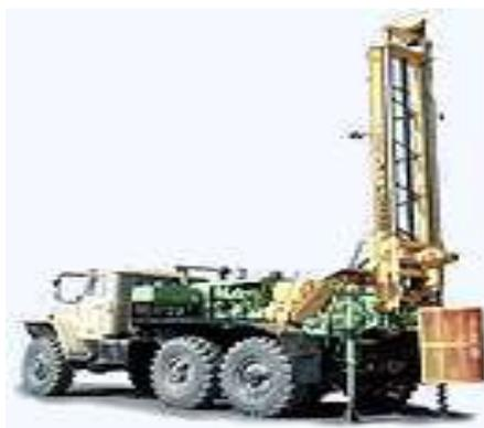
*Рис. 9. Буровая установка вращательного и ударно канатного бурения ПБУ–2*
