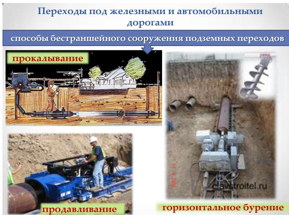
Рис. 5.10.7.а. Способы сооружения подземных переходов
