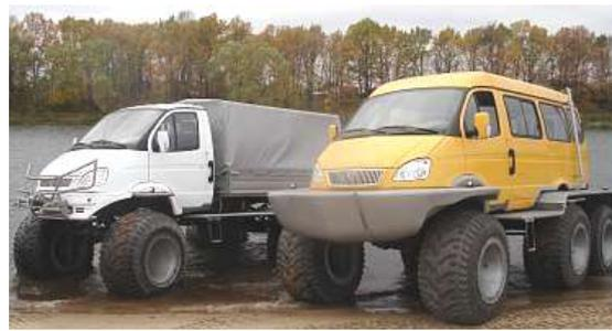
*Рис. 49. Снегоболотоход на цилиндрических колесах*
