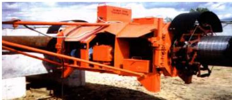
*Рис. 30. Очистная машина типа ОМ – Э*
