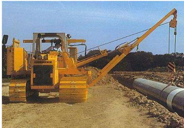
*Рис. 61. Трубоукладчик LIEBHERR RL – 22 B Litronic*
