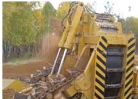
*Рис. 10. Машина для вскрытия трубопроводов*
