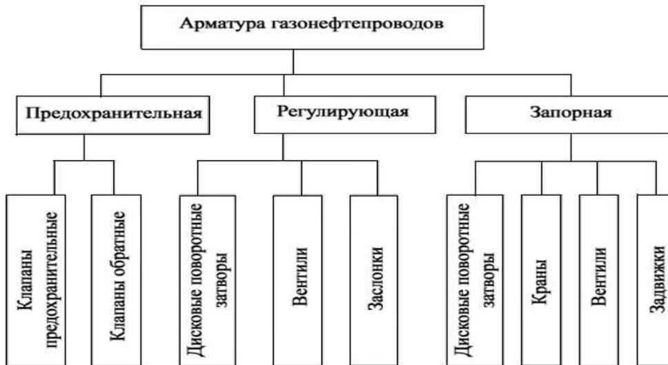
Рис. 2.10.1. Арматура газонефтепроводов
