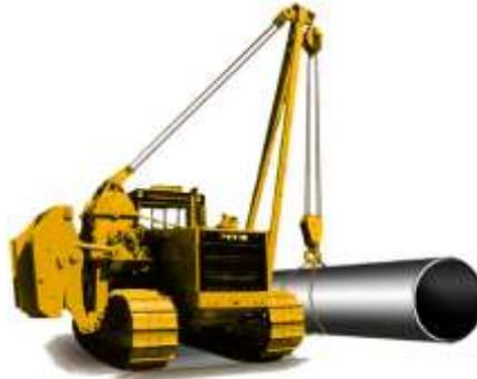
*Рис. 59. Трубоукладчик на гусеничном ходу*
