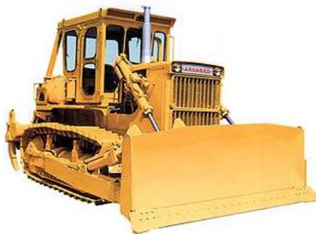
Рис. 8. Бульдозер с рыхлителем
