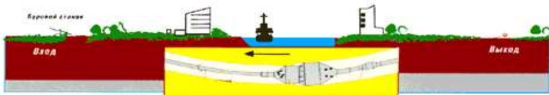
Рис.6. Расширение скважины
