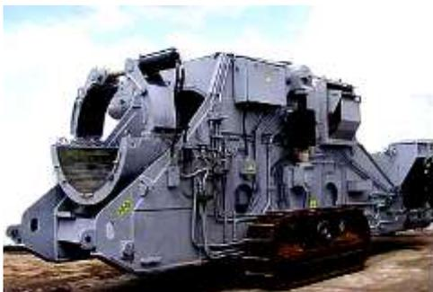
*Рис. 57. Трубогибочная машина ГТ*
