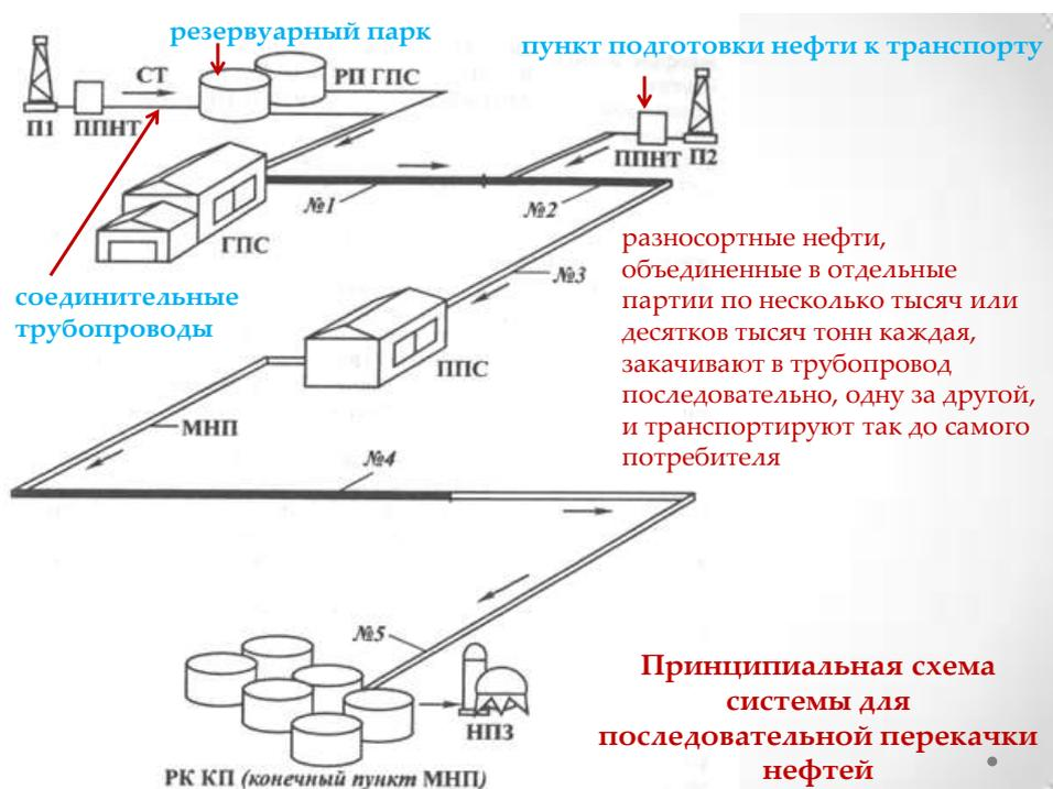
Рис. 2.3.2.1. Схема последовательной перекачки нефти
