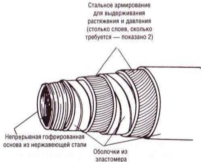
Рис. 2.9.2.2. Конструкция гибкой трубы
