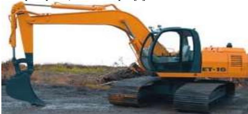
*Рис. 64. Экскаватор одноковшовый гусеничный гидравлический ET – 16.*
