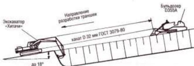
Рис. 5.6.5 - Разработка траншеи на продольных уклонах до  $18^\circ$  методом сверху вниз с якорением экскаватора бульдозером
