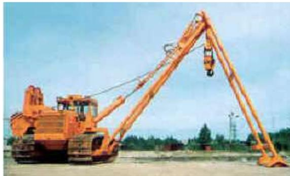
*Рис. 60. Трубоукладчик ТБ – 4 со стрелой – опорой*
