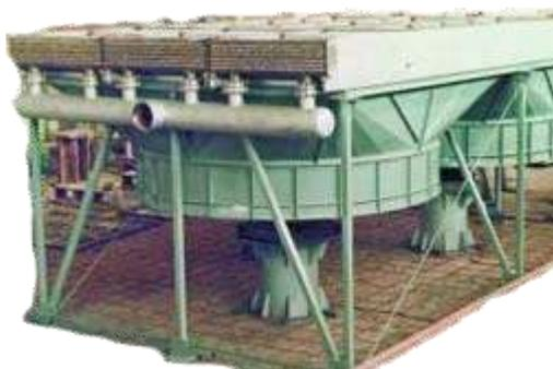
*Рис. 1. Аппарат воздушного охлаждения*
