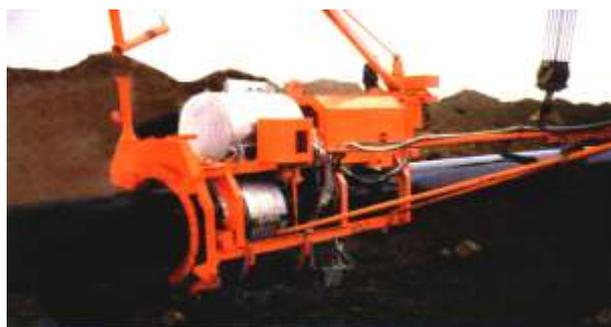
Рис. 23. Изоляционная машина типа МИАБ
