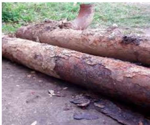
Рис. 17. Коррозионное разрушение труб (с сайта <http://www.nppts.ru>)
