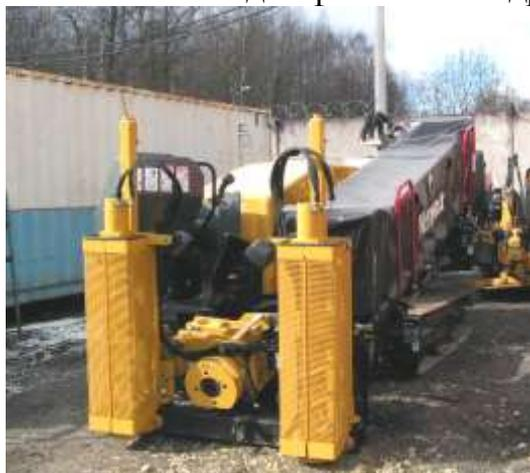
Рис.5.10.1. Установка наклонного бурения Vermeer D24 × 40 Series II Navigator
