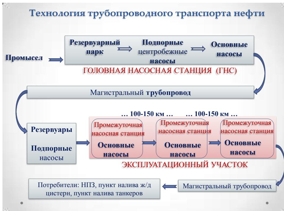
Рис. 2.2.2.1. Технология трубопроводного транспорта нефти
