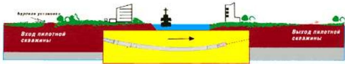
Рис.5. Бурение пилотной (лидерной) скважины
