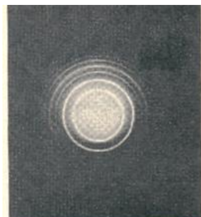
Фотография, полученная при дифракции электронов на белом олове.
