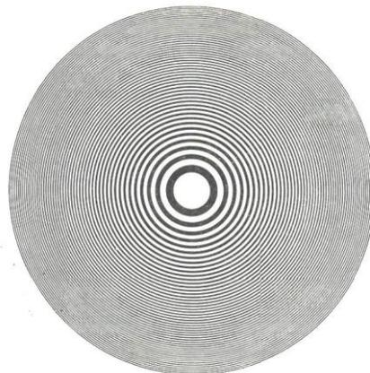
Рис.5. Зонная пластинка Френеля.
